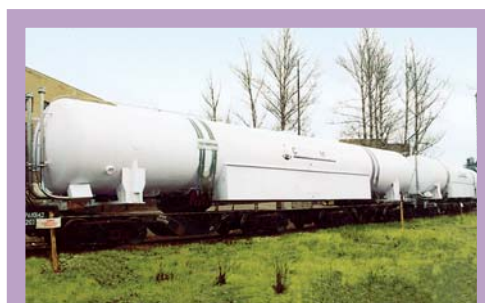
Фото 7. Криогенный водородный резервуар ёмкостью 100 м 3
